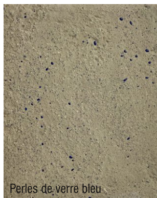
Perles de verre bleu 10 l préformulé kaki (FA06) + 50 g perles de verre bleu
