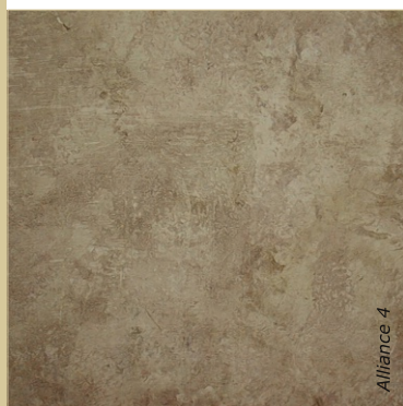
Glacis appliqué à l'éponge sur enduit à la chaux brut, teinté au pigment ombre naturelle.
