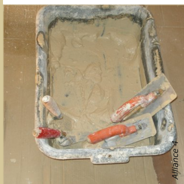
Les outils pour l'application d'un enduit de finition : truelle, langue de chat, grand ou moyen platoir pour l'application, petit platoir arrondi pour le lissage.
