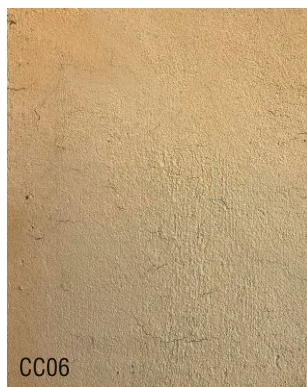
CC06 Chaux aérienne en pâte 1 vol + 5 vol sable roulé 0-4 + 15% sienne naturelle
